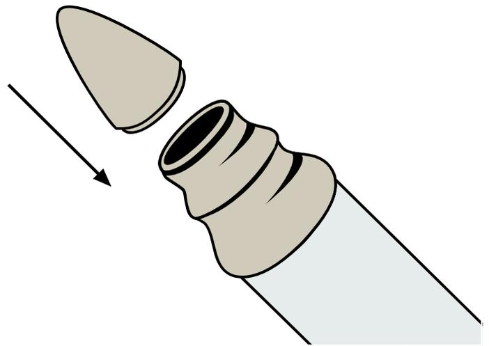
5) Mit Stauring Größe 20 beginnen und diesen mittels des Konus und etwas Gleitmittel auf das offene Ende des Zylinders schieben. Konus entfernen. Sollte dieser Ring zu **groß** sein, den nächst **kleineren** Ring ausprobieren.
